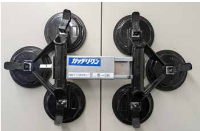
目地幅の調整をスムーズにする、専用工具「ガッチリケン」 （特許取得済）
