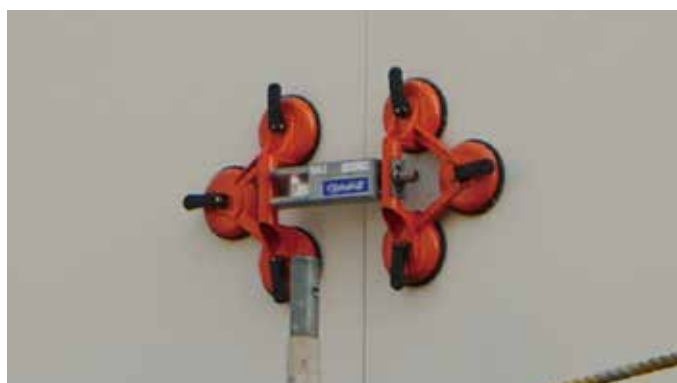
目地幅の調整をスムーズにする、専用工具「ガッチリケン」 （特許取得済）
