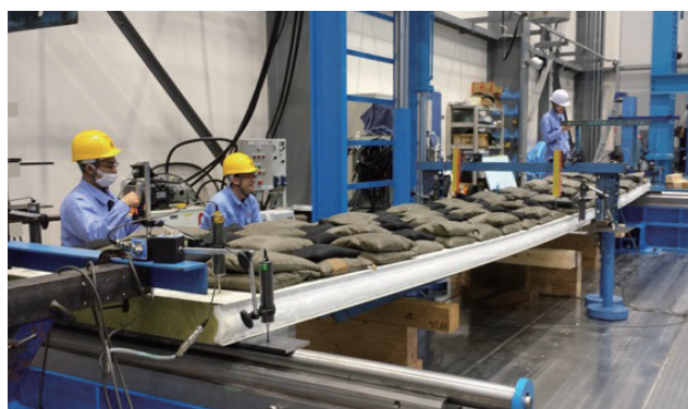
等分布荷重での曲げ試験(建材試験センター)
