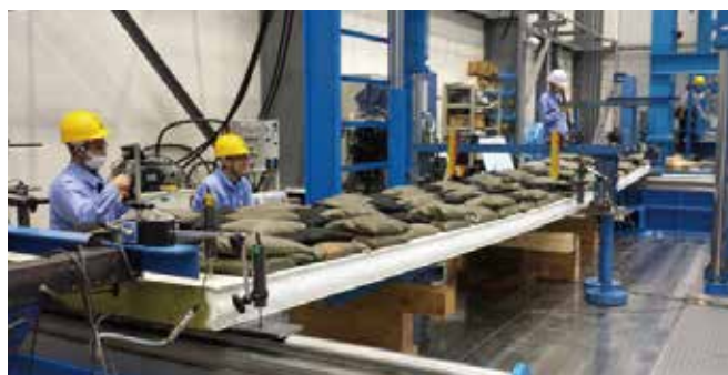
等分布荷重での曲げ試験 (建材試験センター)
