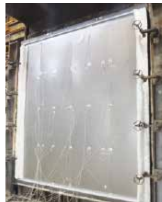
耐火1時間試験 (建材試験センター)
