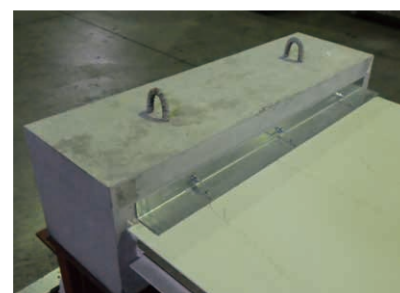
コンクリートブロックにアンカー留めた試験体 (パネル上部支持部分)
